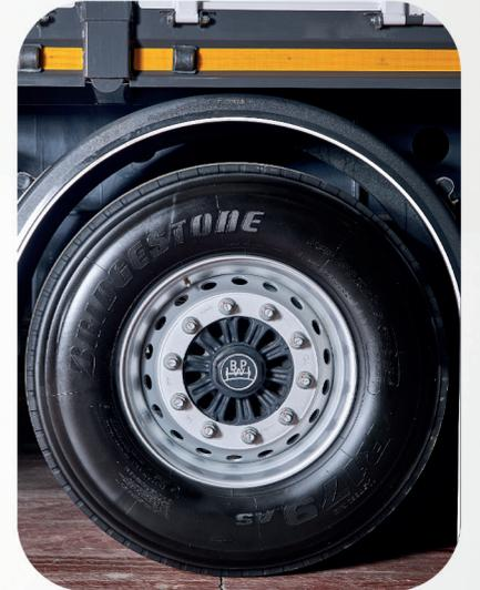
**BPW** BPW Havalı süspansiyonlu ve disk frenli dingil
